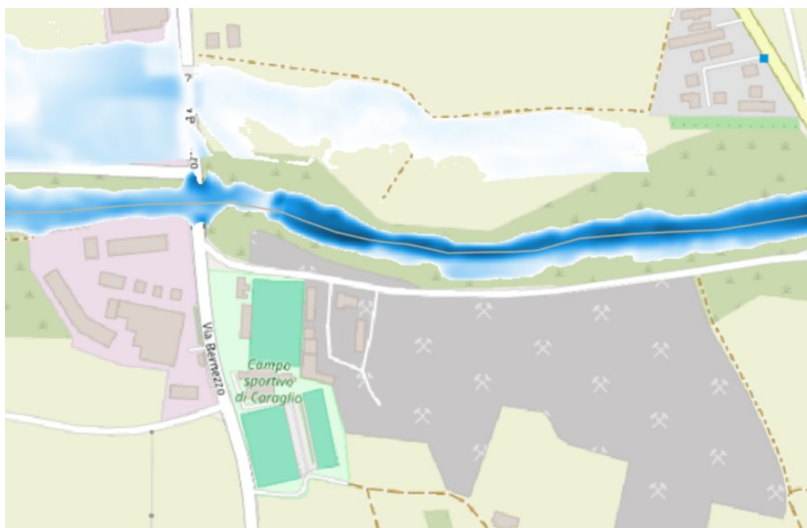
Figura 7.5: altezze d'acqua - Modello misto 1D-2D - Tratto di valle
